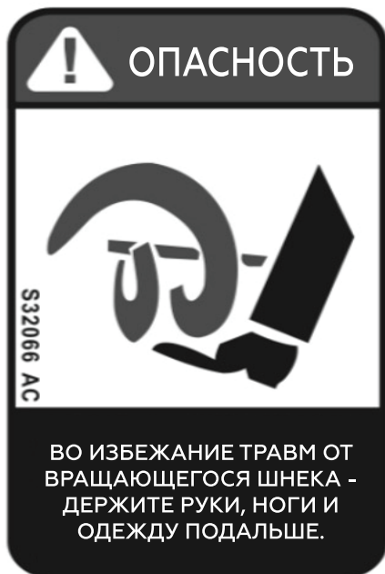
Предупреждающая табличка на корпусе шнека
