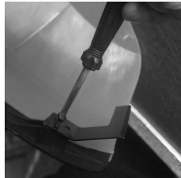
Установите трансмиссионную штангу в корпус редуктора до упора. Убедитесь, что приводной вал передает вращение на шпindel редуктора. Закрепите штангу в редукторе болтом.
