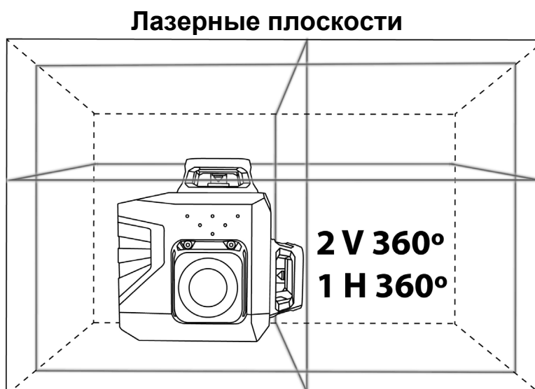
Рис.3. Лазерные плоскости ПЛ-3х360ШС Green
