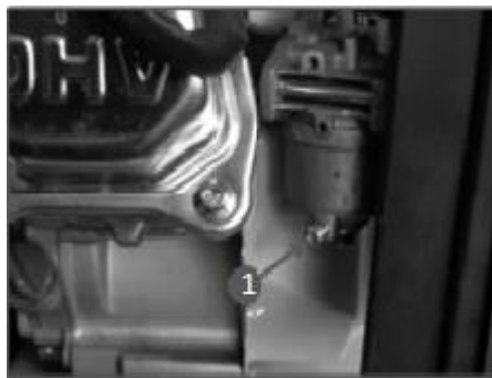
Рис. 24 Обслуживание фильтра отстойника Т-50 1. Винт
