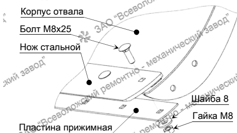
Рис.5 Крепление ножа
