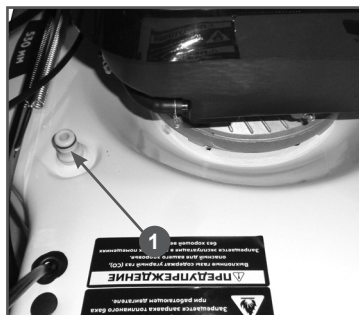
Рис. 29 Расположение коннектора для подключения шланга А - коннектор
