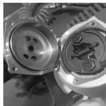
Установите штангу в отверстие корпуса сцепления до упора. Убедитесь, что вращение передается с чашки сцепления на приводной вал штанги. Закрепите штангу в корпусе сцепления с помощью винта.
