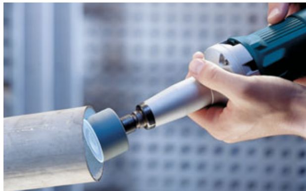
Шлифкольца идеально подходят для удаления заусенцев
